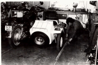
Mesure du pincement des axes des roues du side par rapport à la moto et du côté et du réglage des côtés « a » et « b » pour obtenir le pincement.
